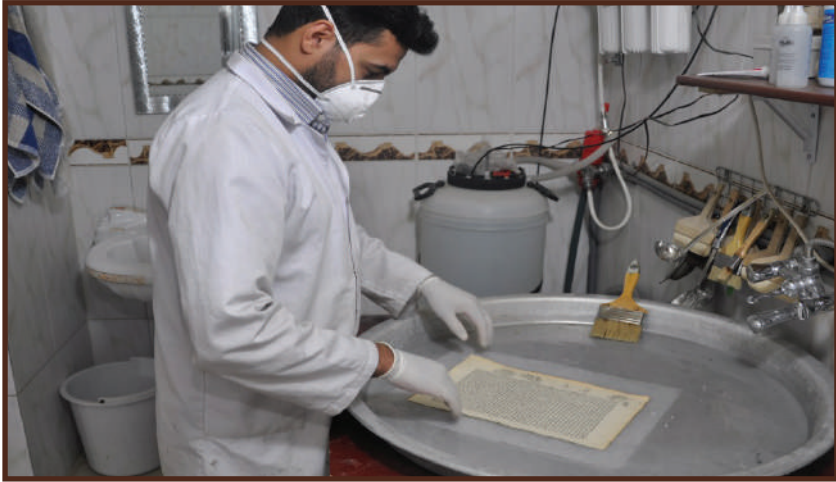
(إزالة حموضة الأوراق غير الحساسة للماء باستخدام المحاليل المائية)
