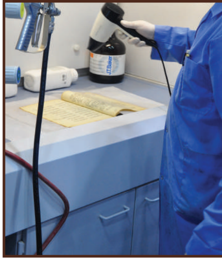
صورة توضّح تعريض الأوراق بعد المعالجة إلى هواءٍ دافئٍ لتجفّ
