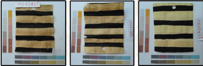
لوحة رقم (٣) التغير اللوني لورق البردي المحبر بحبر العنص الحديدي قبل التقادم (١) وبعد التقادم الحراري (٢) والطبيعي (٣) بترتيب العينات
